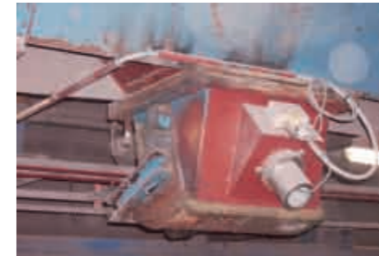
Installation der Mikrowellenfeuchtemeßsonde im Siloauslauf
