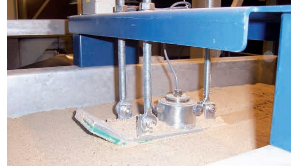
Installation der Mikrowellenfeuchtemeßsonde auf einem Förderband
