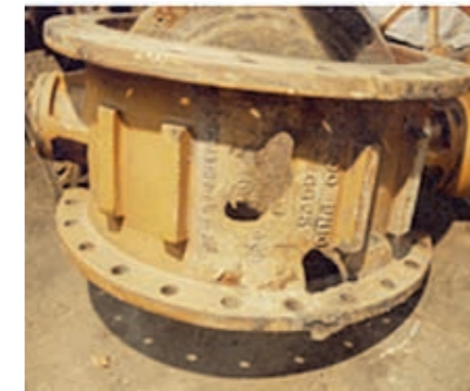
Verschlossenes Schiebergehäuse – vor Reparatur
