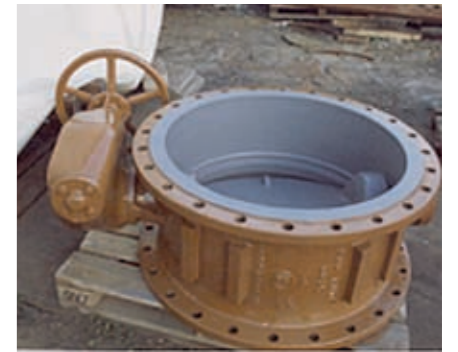
Mit SC-Erottox repariertes Schiebergehäuse
