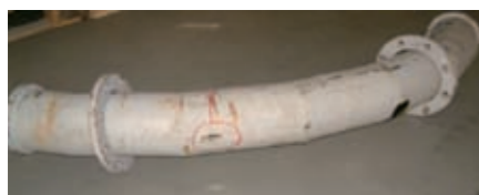
Zerschossener Rohrbogen DN 80, R1000
